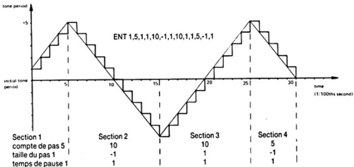
Figure 4: caractéristiques d'une enveloppe de ton
